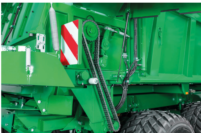
Der Fräswalzenantrieb erfolgt über eine Duplex-Rollenkette. Der massive Kettenspanner kann bei geschlossenem Schutzkasten kontrolliert und nachgespannt werden.
