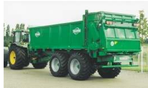
HS 180 в особой окраске и сменными бортами и резиной 710/50 R 26,5 «Michelin Cargo X BIB»
