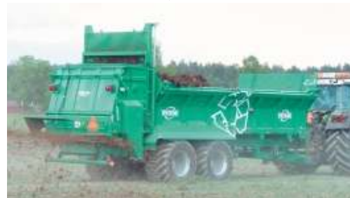
HS 220 с наклонными стальными бортами имеет 20 м 3 погрузочного объёма и резину 800/40 – 26,5 профиль 423.
