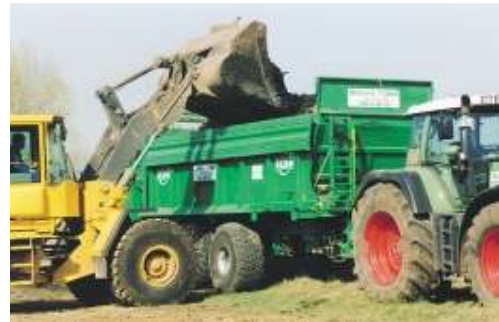
HS 220 с наклонными стальными бортами имеет 20 м 3 погрузочного объёма и резину 800/40 – 26,5 профиль 423.
