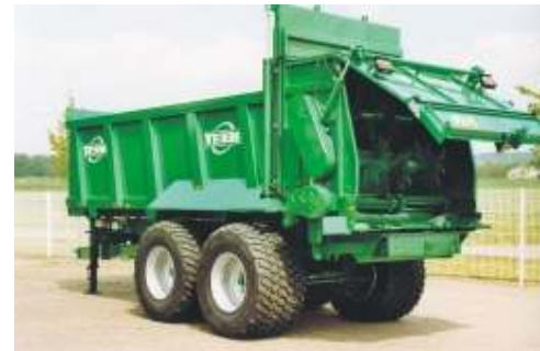
HS 180 – стандартная машина для платных предприятий. Полезный объём – 15 м 3 .
