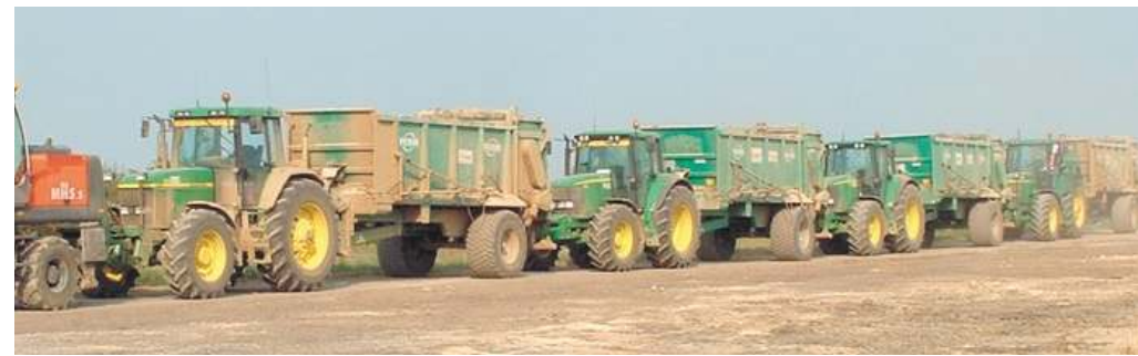
HS 180 – стандартная машина для платных предприятий. Полезный объём – 15 м 3 .
