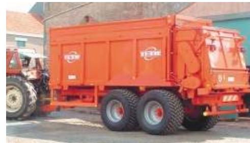
HS 180 в особой окраске и сменными бортами и резиной 710/50 R 26,5 «Michelin Cargo X BIB»
