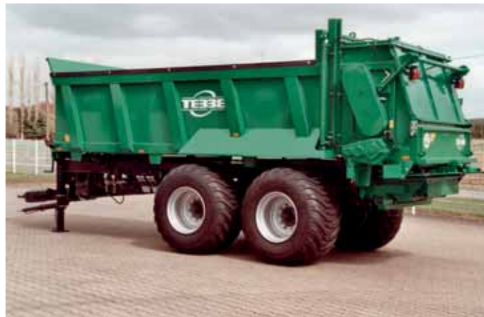
HS 180 vaihtolavajärjestelmänä, 1250 mm korkealla täyshitsatulla teräslavalla.
