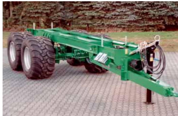
Vaihtolavoja nostetaan ja lasketaan kaksitoimisilla sylintereillä.
