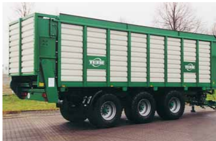
Koska levittimen ja rehuvaunun käyttöajankohdat eivät osu yhteen, on yhteistä alustaa käytetty näihin tarkoituksiin jo vuosia.
