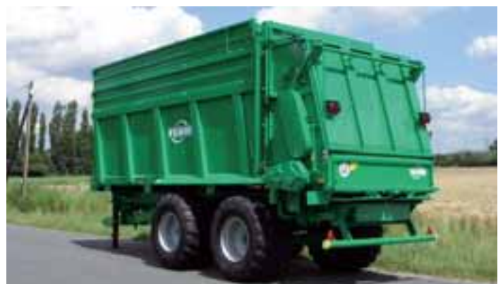
Zum Ausstreuen von sehr leichten Streugütern kann der HS 220 mit doppelten Aufsatzwänden ein maximales Ladevolumen von 32 cbm erreichen. Das 3-Walzen-Streuwerk hat 1900 mm Innenhöhe.
