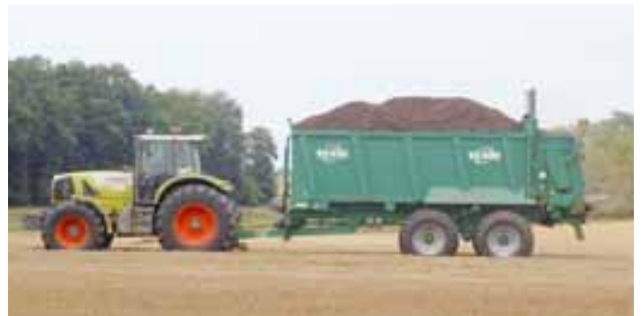
Zum Ausstreuen von sehr leichten Streugütern kann der HS 220 mit doppelten Aufsatzwänden ein maximales Ladevolumen von 32 cbm erreichen. Das 3-Walzen-Streuwerk hat 1900 mm Innenhöhe.
