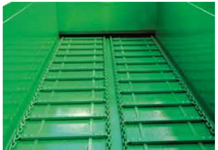
Alle DS-Streuer haben in der Grundausstattung einen Rollboden mit vier 14 x 50 mm starken Rundstahlketten mit 24 t Bruchlast je Kette.
