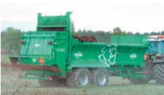
HS 220 mit schräggestellten Stahlbordwänden hat 20 cbm nutzbares Ladevolumen und Bereifung 800/40 - 26,5 Profil 423
