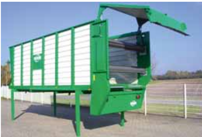
Silotrailer als Aufbaueinheiten für Tandemfahrgestelle mit 43 cbm Ladevolumen und bis zu 60 cbm Ladevolumen für Tridem-Fahrgestelle.
