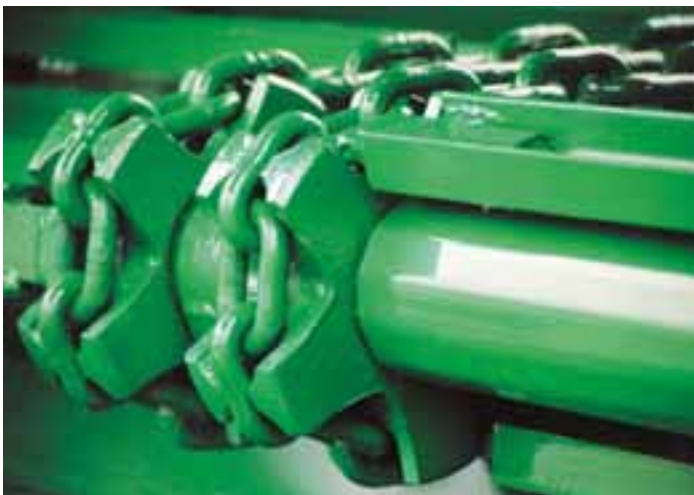
Alle DS-Streuer haben in der Grundausstattung einen Rollboden mit vier 14 x 50 mm starken Rundstahlketten mit 24 t Bruchlast je Kette.
