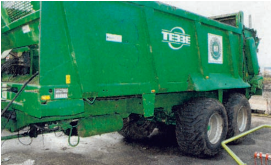
Eng zusammenstehende Achsen schonen das Vorgewende. Druckluftbremse ist Serie.
