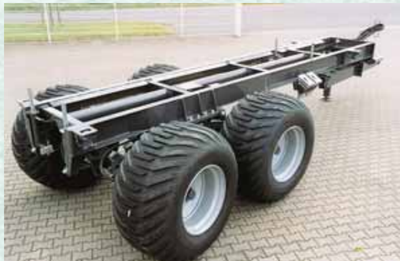
Tandemfahrgerüst mit Wechselsystem und Buggyfahrwerk mit 1.900 mm Achsabstand für ein zul. Ges.Gew. von 23.000 kg.
