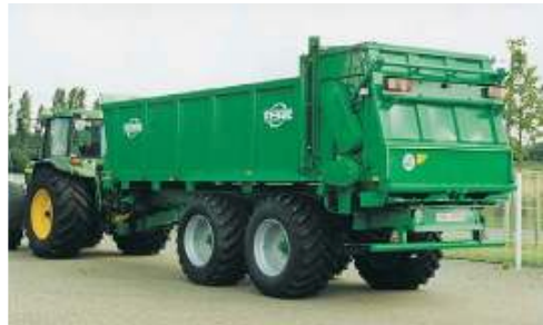
HS 180 in speciale kleur met opzetschotten en banden 710/ 50 R 26,5 Michelin Cargo X BIB.
