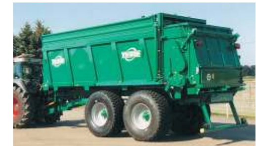
HS 220 met 1400 mm stalenwand en 600 mm opzetschotten, laadvolume van 25 m 3 . Banden 650 / 65 R 30,5 Michelin Cargo X BIB.
