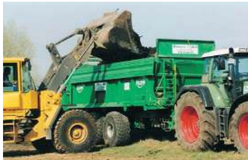
HS 220 in standaard uitvoering met 18,5 m 3 laadvolume en banden 700/50 - 30,5 profiel 331.
