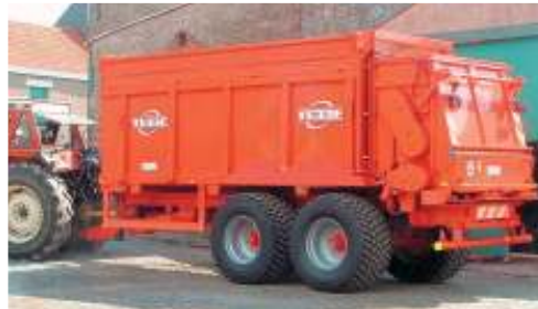
HS 180 in speciale kleur met opzetschotten en banden 710/ 50 R 26,5 Michelin Cargo X BIB.
