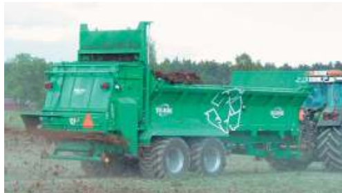
HS 220 met schuin geplaatste wanden heeft 20 m 3 laadvermogen met banden 800/40800/40 – 26,5 profiel 423.
