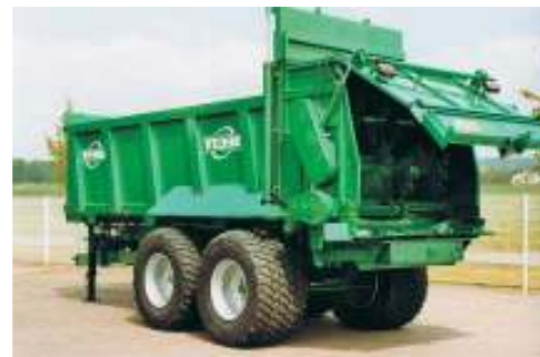
De HS 180, de meest voorkomende machine voor de loonwerker. Met een laadvolume van 15 m 3 .
