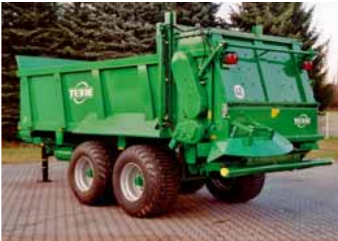
DS 160 mit abgesenktem Grenzstreuschirm und Schutzplatte in der Rückwand.
