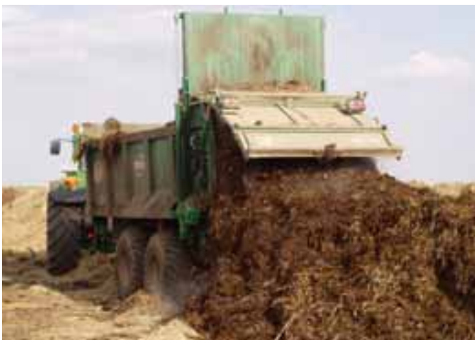
DS 160 mit abgesenktem Grenzstreuschirm und Schutzplatte in der Rückwand.
