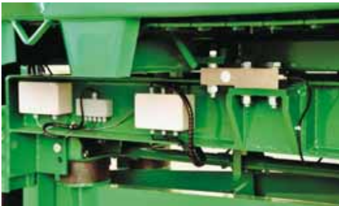
Das Wiegesystem ist mit 4 oder 6 Wiegezellen mit jeweils 10 t Traglast ausgestattet.
