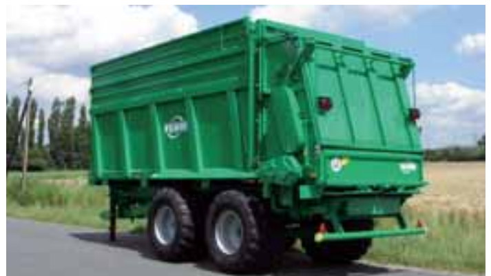
Zum Ausstreuen von sehr leichten Streugütern kann der HS 220 mit doppelten Aufsatzwänden ein maximales Ladevolumen von 32 cbm erreichen. Das 3-Walzen-Streuwerk hat 1900 mm Innenhöhe.
