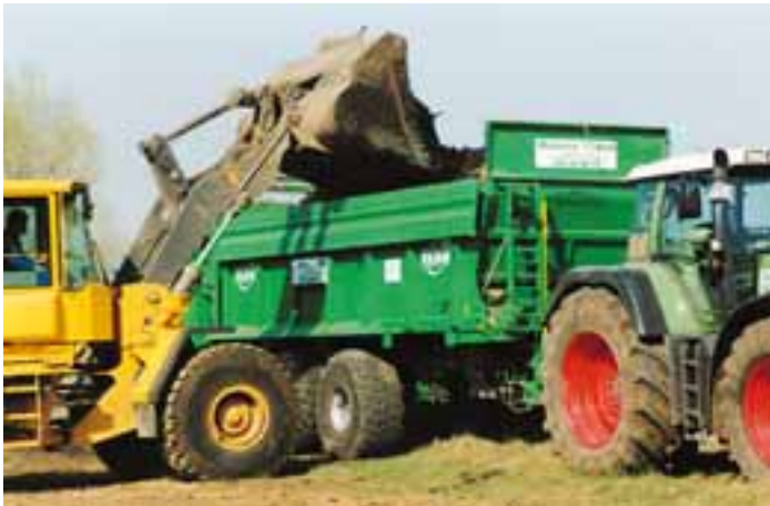
HS 220 mit schräggestellten Stahlbordwänden hat 20 cbm nutzbares Ladevolumen und Bereifung 800/40 - 26,5 Profil 423
