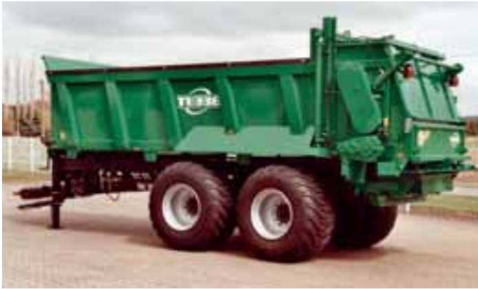
Der HS 180 als Wechselsystem mit 1250 mm hohem vollverschweißtem Stahlaufbau.
